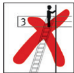
Die obersten 3 Stufen nicht besteigen
