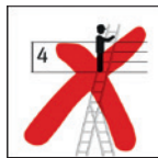
Die obersten 4 Stufen nicht besteigen
