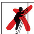
Nicht als Anlegeleiter nutzen
