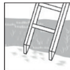
Stahlspitzen auf nachgiebigem Untergrund
