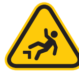
Warnung vor Absturzgefahr
